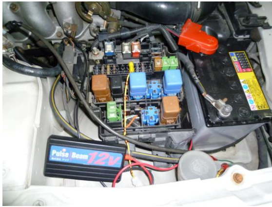
図 3 ヒューズボックスへの Pulse Beam 装着状態
