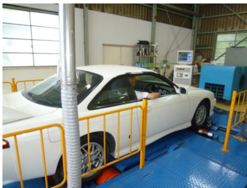
図1 シャシダイナモメータ上での走行試験
