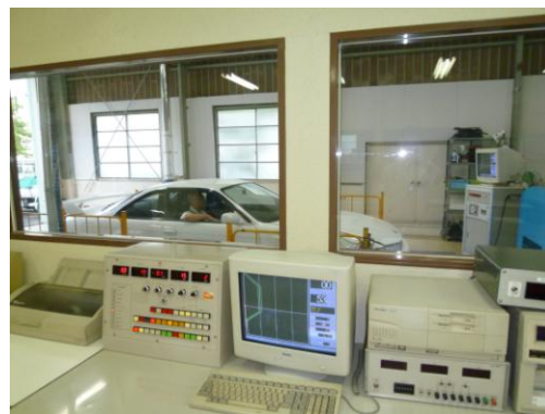
図2 シャシダイナモメータ制御盤
