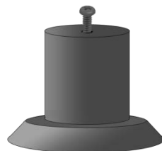
端子に穴を開ける (ビス仕様：M4×10 タッピング)
